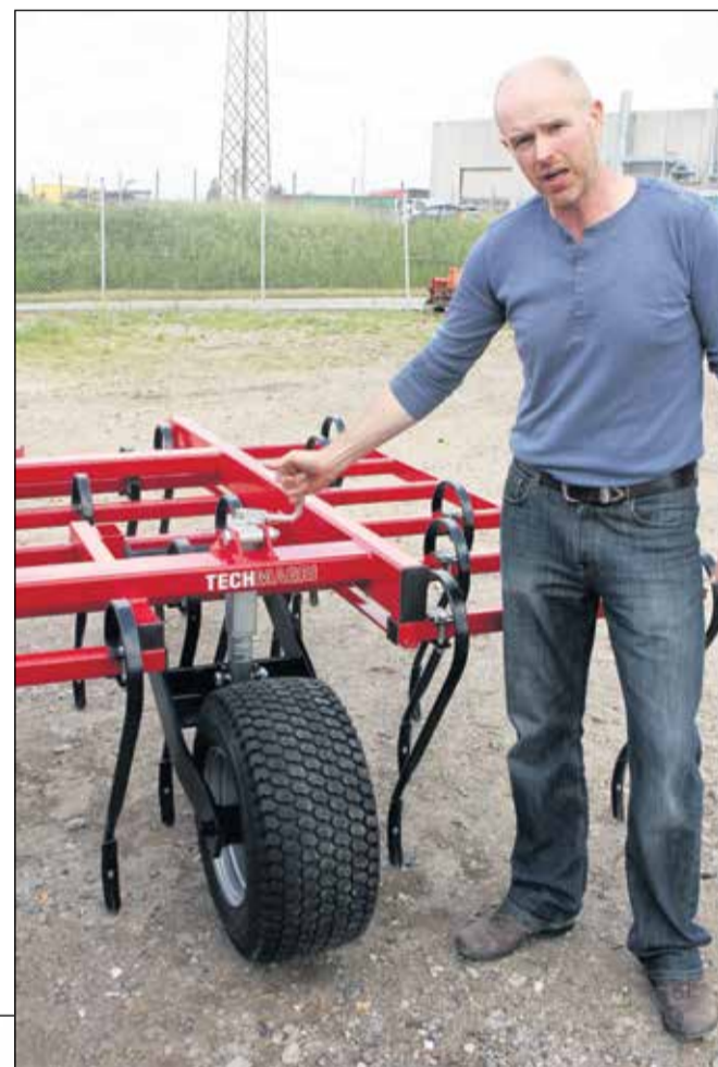
Torben Søeberg fra Twendesminde ved Kolding viser her, hvordan halmharvens arbejds højde stilles, så tænderne kun lige berører jordens overflade. - Meningen er, at harven skal fordele og sprede halm, mens den svines en smule til med jordbakterier, forklarer han. (Fotos: Bøje Østerlund)
