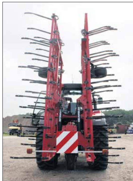
Techmagri halmharven kan parkeres i opslået tilstand på fire parkeringsben, så den ikke fylder meget i maskinhuset.
