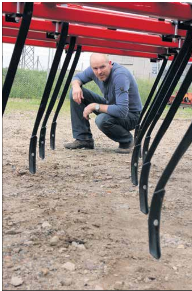
Torben Søeberg fra Tvendegaard ved Kolding viser her, hvordan der er masser af gennemgang i den nye halmharve, der har 660 millimeter frihøjde under rammen. (Fotos: Bøje Østerlund)
